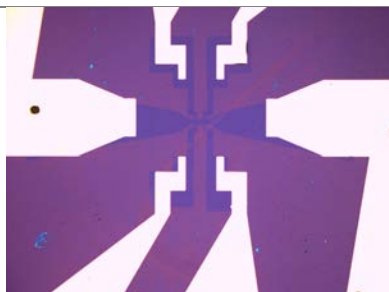
Barre de Hall en graphène réalisée par les étudiants au C2N
