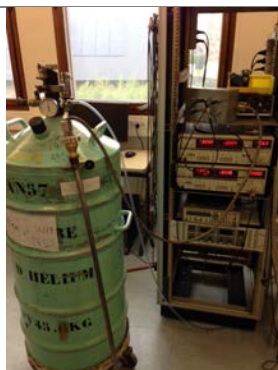
Setup de mesure avec canne et bouteille d'Hélium
