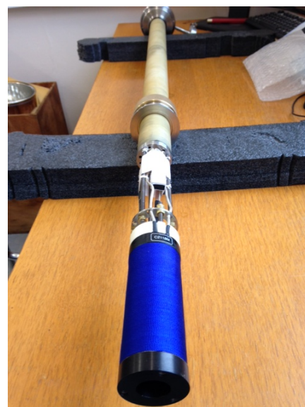
Aimant supraconducteur utilisé en TPs (5Teslas pour 50 A environ)
