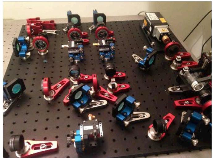
*A gauche : enceinte à vide dans laquelle un jet d'atome est produit à partir d'une vapeur saturante puis manipulé et détecté à l'aide de faisceau laser dans une chambre munie de hublots en verre. A droite : banc optique réalisant l'asservissement en fréquence d'un laser à diode sur la transition atomique de l'atome de Rubidium 87 et la dérivation de trois faisceaux laser de fréquence indépendamment accordable à l'aide de modulateurs acousto-optiques.*
